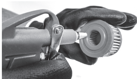
Fig. 10 – Remoção e limpeza do filtro
